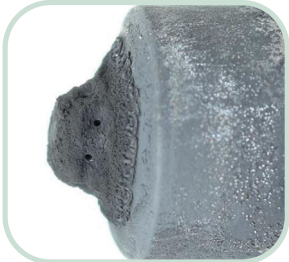
Dieselbe Einspritzdüse nach 5.000 km mit Shell FuelSave Diesel.
