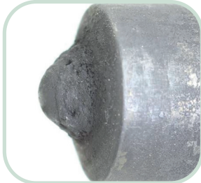
Verschmutzte Einspritzdüse in einem britischen LKW nach Verwendung von Standard-Diesel.
